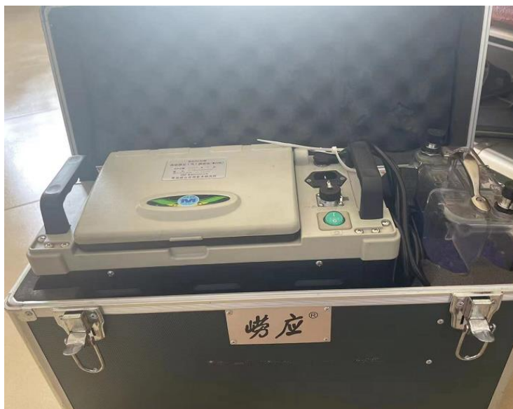
图 4-12 自行检测设备—崂应 3012H 自动烟尘（气）测试仪
